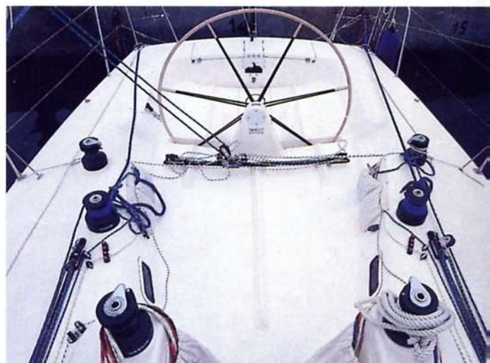
*Quello dell'IMX 38 è un tipico esempio di pozzetto da racer: lungo m 3,30 e largo m 1,75 è disegnato secondo le ergonomie di manovra. I puntapiedi assicurano l'equilibrio a barca sbandata.*
